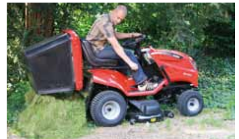
Bequeme Entleerung des Grasfangsackes ohne die Sitzposition zu verlassen
